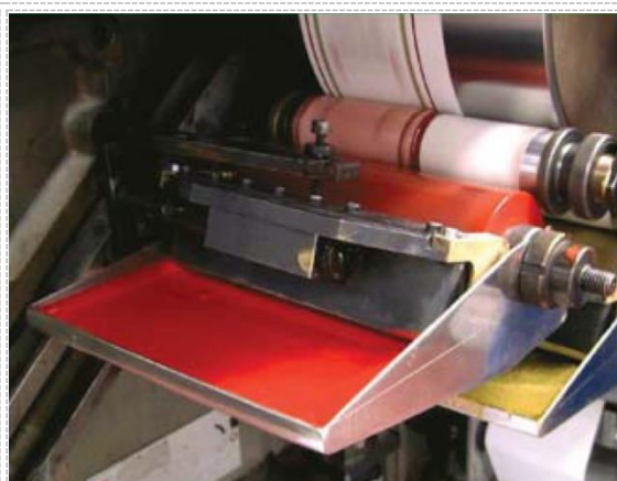
Tinta eltávolítása a flexográfiai nyomdahengerekről
